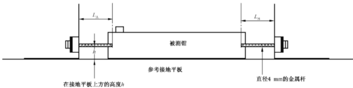
图 A.5 插入被测钳的试验夹具
