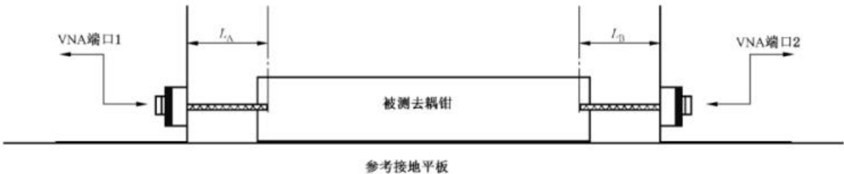
图 A.12 去耦钳特性的测量布置
